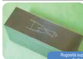
Rugosità superficiale (Rz): 1µm Surface Roughness
