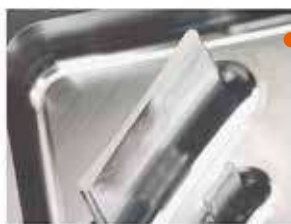
R1×8 tagliente dopo lavorazione Cutting edge after machining
