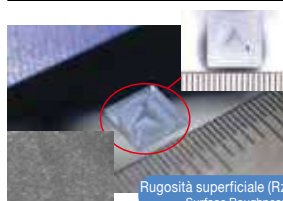
Rugosità superficiale (Rz): 1.4µm Surface Roughness
